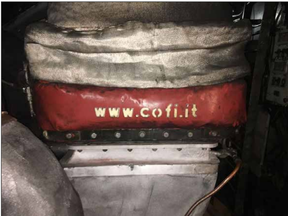
Giunto compensatore COFLEX® T Modello GGGA1 per gas di scarico su motori navali militari anti-shoc, temperatura fluido 450/500°C, temperatura esterna 60°C.
